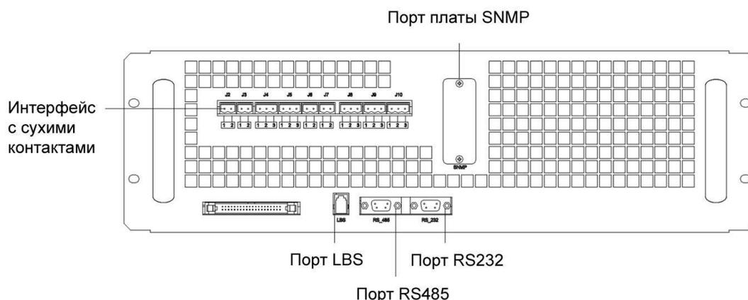
Рис. 1-12. Интерфейс с "сухими" контактами и коммуникационные интерфейсы
