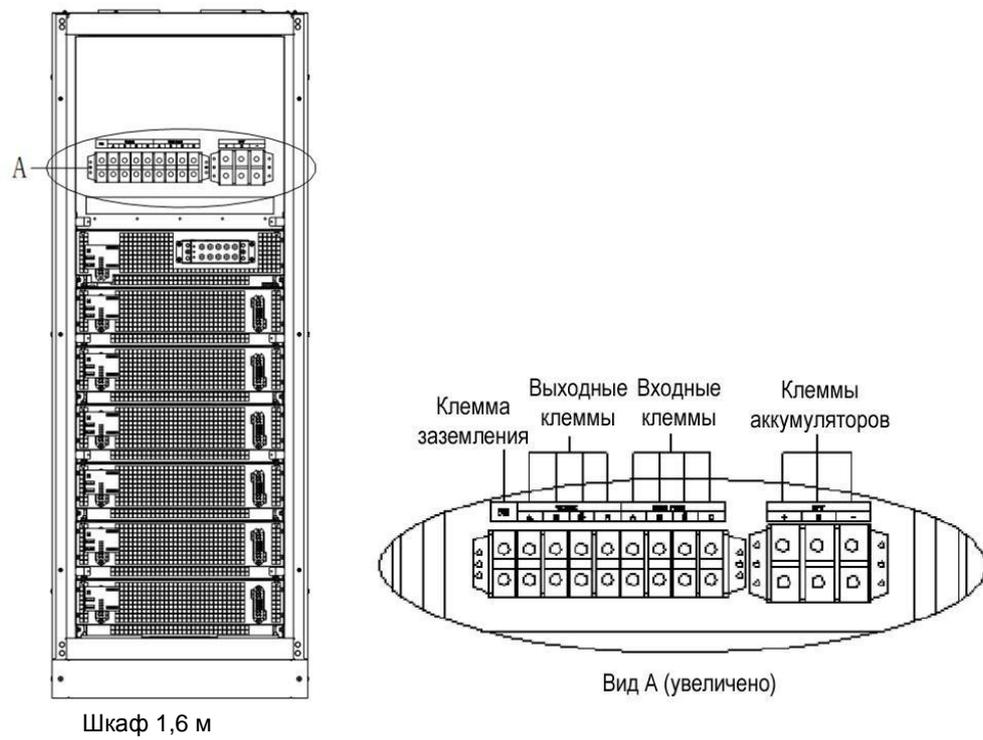
Рис. 1-23. ИБП, вид сзади
