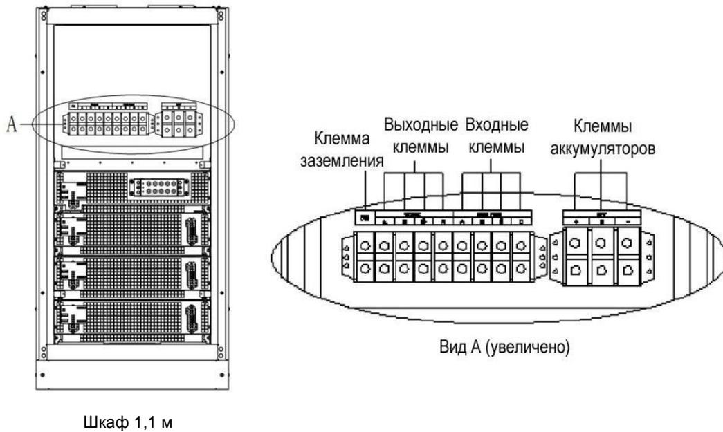
Рис. 1-23. ИБП, вид сзади
