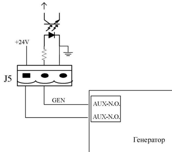
Рис. 1-15. Схема интерфейса состояния и подключения генератора
