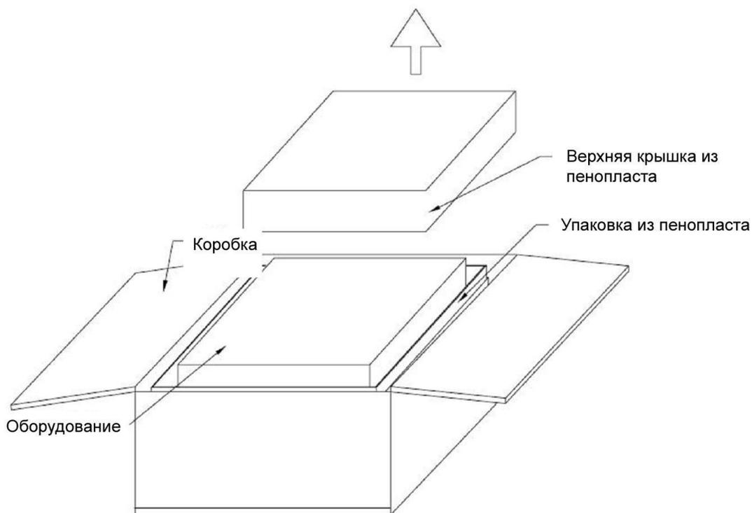
Рис. 1-6. Удаление крышки из пенопласта
