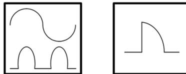
Рис. 1-10. Обозначения УЗО
